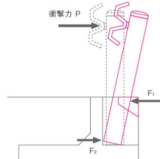
せん断破壊メカニズム図
