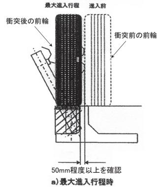
図 前輪が路面に残る幅の説明図
